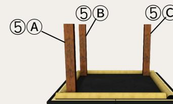
Insérer ⑤Pilier (A), Pilier (B), Pilier (C) dans la base par le haut. Ce faisant, installez le pilier sur le côté gauche de manière à ce que la plaque signalétique soit orientée vers l'avant. La cheville à tête sphérique installée dans le pilier doit toujours se trouver à l'extérieur.
