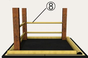
Installer le bambou horizontal entre les colonnes en insérant le ⑧ bambou horizontal dans les trous des colonnes. Insérez l'extrémité du bambou horizontal avec l'incision dans le pilier (B). Le côté coupé doit être orienté vers l'intérieur.
