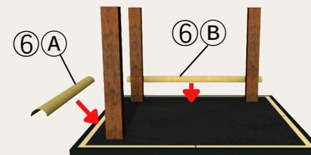
Les évidements latéraux des ⑥bambou fendu (A), bambou fendu (B) sont placés sur les chevilles à tête sphérique des pilier (A), (B) et (C).
