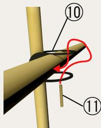
Insérez la ⑫ cale de bambou dans le trou à la jonction entre le pilier et le bambou pour l'utilisation horizontale et fixez-la en place.
