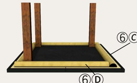
Couvrir les bambous fendus (C) et les bambous fendus (D) connectés avec les chevilles à tête sphérique du pilier (A) et du pilier (C) par le haut.
