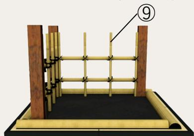
⑨ Installer le bambou vertical dans l'alignement du creux du bambou horizontal. Ce faisant, le côté du bambou vertical présentant des nœuds doit être orienté vers le haut et le côté présentant des fissures doit être orienté vers l'extérieur.
